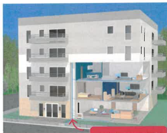
Arrivée de la fibre en souterrain
